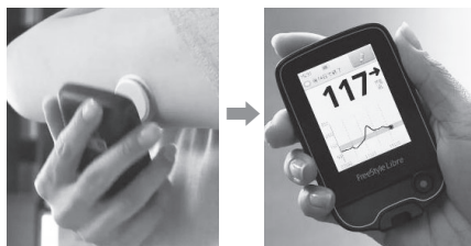
※腕に装着したセンサーに機械をかざすと、血糖値が表示される。 ※健康診断では分からない食後高血糖を把握することができます。
